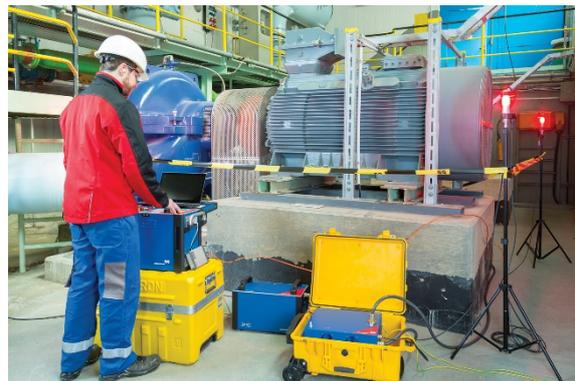
Die 15-kV-Prüflösung von OMICRON für rotierende Maschinen umfasst das universelle Prüfgerät CPC 100, das CP TD15 mit Hochspannungsquelle und Verlustfaktormessung sowie die Kompensationsdrossel CP CR600.
