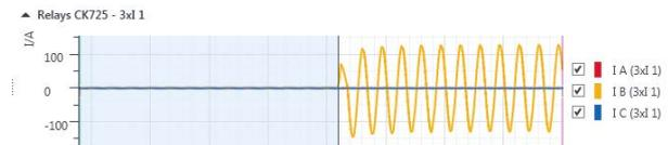
Bild 25: L2-N-Fehler mit simuliertem Stromwandler
