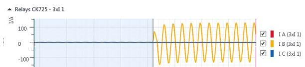
Bild 14: L2-N-Fehler, 67% Remanenz
