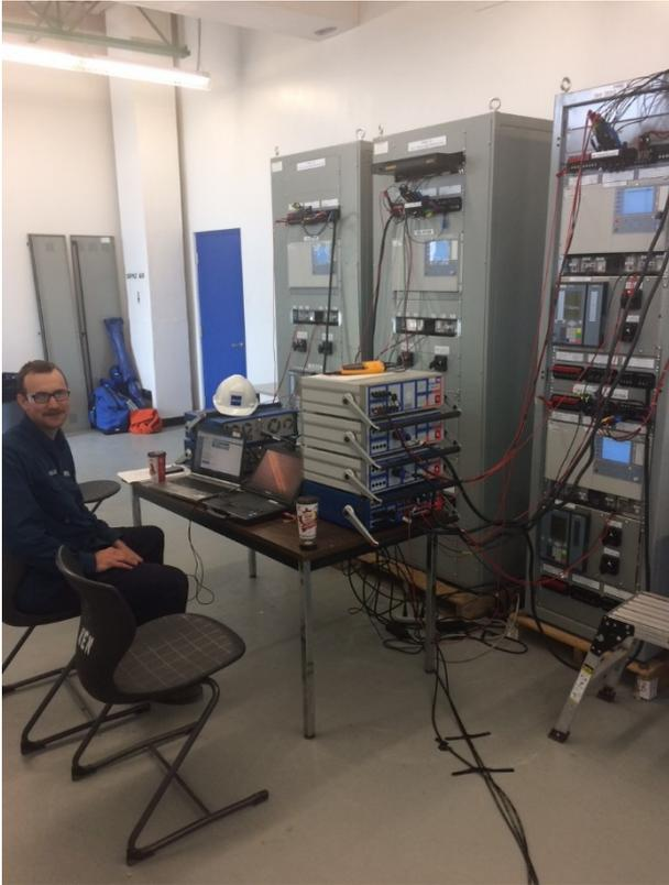
Bild 32: Prüfaufbau für die Prüfung vor dem Einbau
