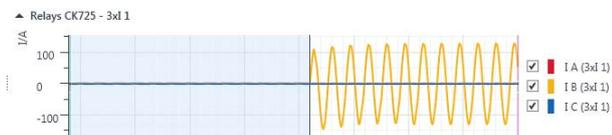
Bild 13: L2-N-Fehler, 0% Remanenz
