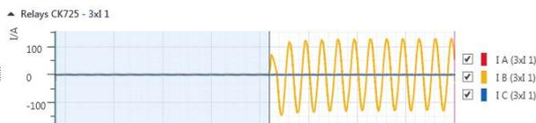
Figure 25: Défaut B-N avec TC simulé
