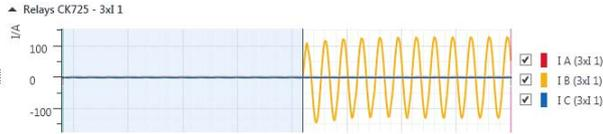
Figure 13: Défaut B-N, 0 % de flux rémanent
