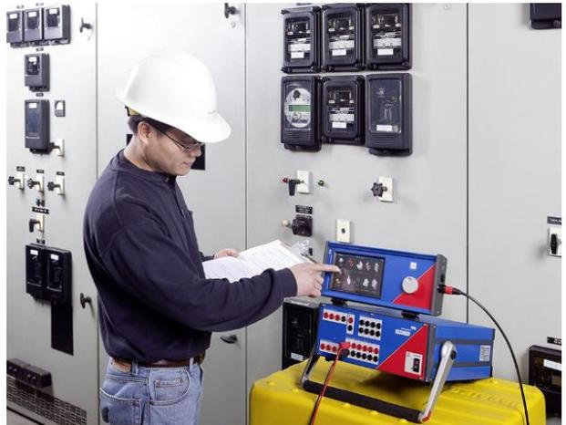
*Imagen 15: Prueba manual rápida con CMControl para tareas simples de prueba*
