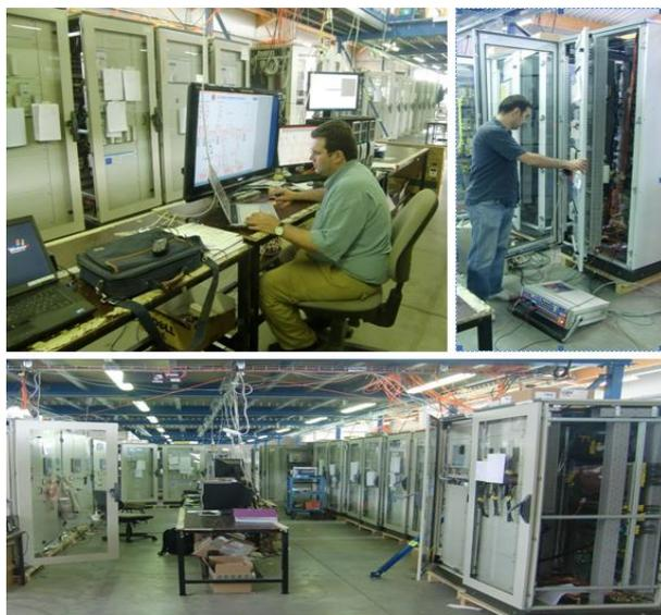
Imagen 4: Prueba de fábrica de un sistema de control digital y protección completo interconectado provisionalmente
