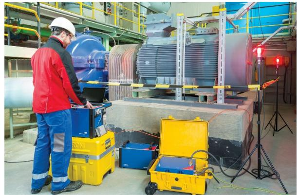
La solución de pruebas de 15 kV de OMICRON para máquinas rotativas incluye el amplificador de tensión CP TD15 y módulo de medición del factor de potencia/disipación, el reactor de compensación CP CR600 y el dispositivo de pruebas multifuncional CPC 100.
