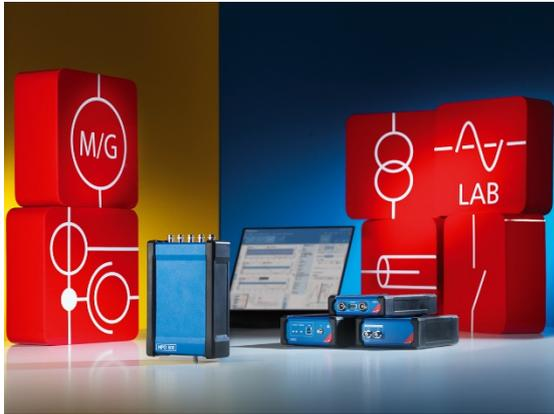
Sistema MPD 800 universal de medición y análisis de descargas parciales.
