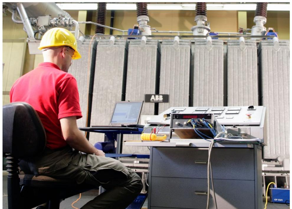
Teilentladungsdiagnose an einem Leistungstransformator
