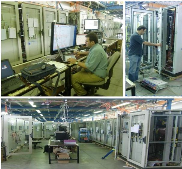
Bild 4: Werksprüfung eines provisorisch komplett verbundenen Schutz- und Leittechniksystems
