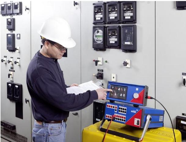
Bild 15: Schnelles manuelles Testen mit CMControl für einfache Prüfaufgaben
