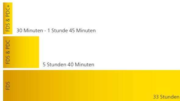
Testzeit für den Frequenzbereich von 1 kHz bis 10  $\mu$ Hz
