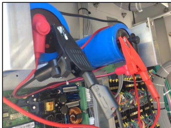
Figura 10 – Medición de la tensión del condensador
