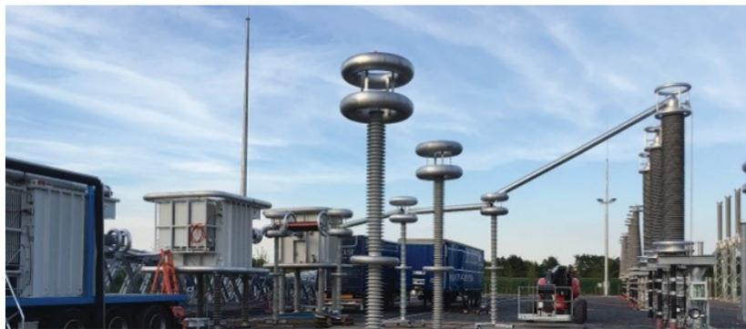
Figura 10. Configuración de la prueba de resonancia para probar sistemas de cableado
