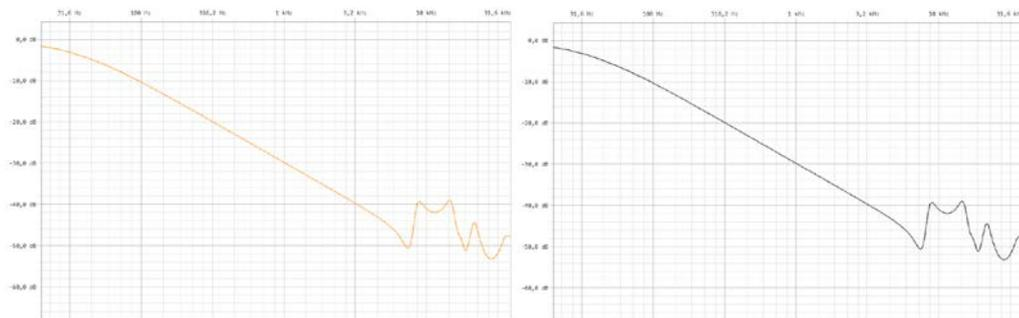
Figura 15: Cortocircuito de extremo a extremo en el devanado de AT realizado con el Instrumento SFRA 1 (izquierda) y el Instrumento SFRA 2 (derecha)
