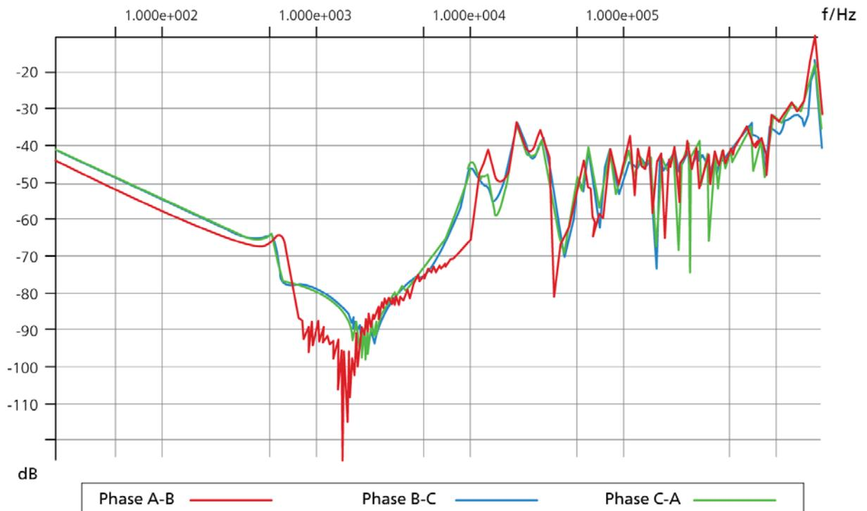
Figura 6: Ejemplo del efecto del piso de ruido en mediciones SFRA en devanados conectados en delta
