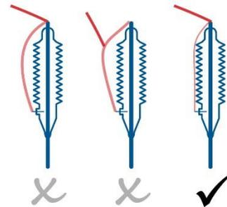
Figura 8: Configuración recomendada según la norma IEC 60076-18
