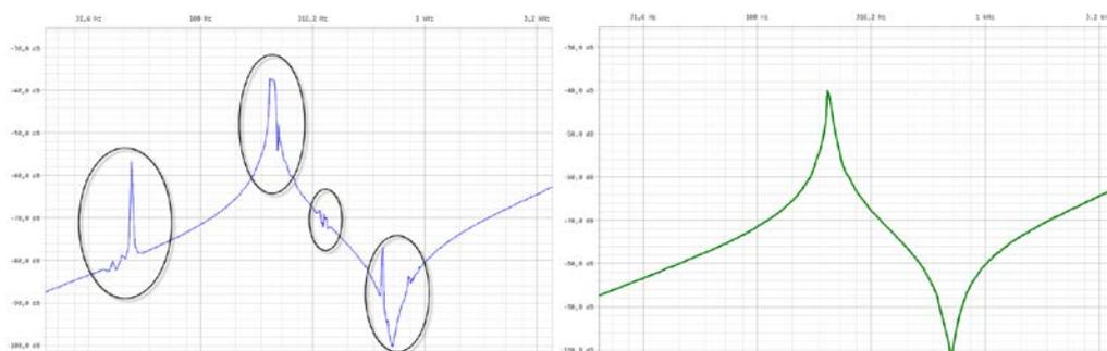
Figura 14: Medición capacitiva entre devanados en el devanado de AT realizado con el Instrumento SFRA 1 (izquierda) y el Instrumento SFRA 2 (derecha)
