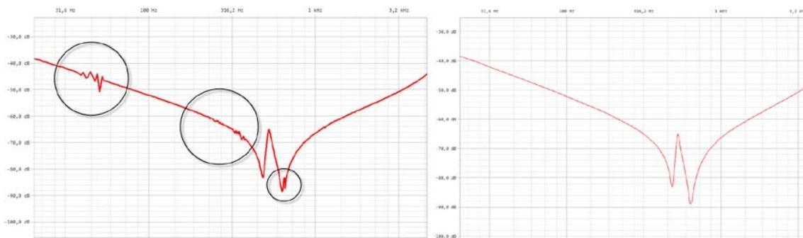
Figura 13: Circuito abierto de extremo a extremo en el devanado de AT realizado con el Instrumento SFRA 1 (izquierda) y el Instrumento SFRA 2 (derecha)
