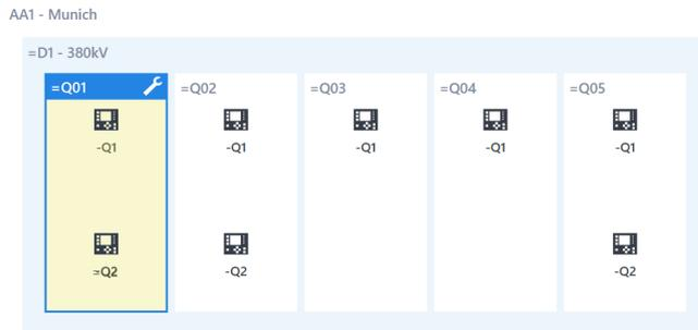
Figure 6 Mode de maintenance activé pour la cellule Q01
