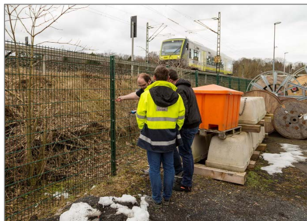
Figura 10 Prueba de tensión de paso y de contacto utilizando COMPANO y HGT1
