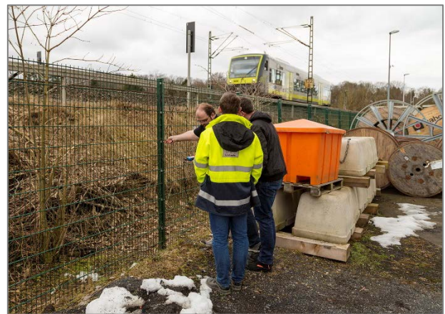
Bild 10 Schritt- und Berührspannungsprüfung mittels COMPANO und HGT1
