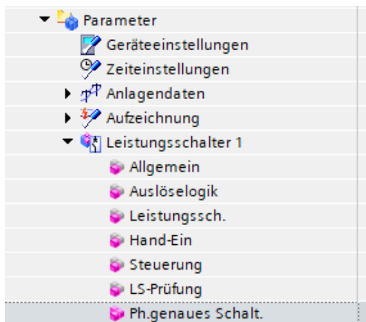
图 11b 断路器功能组中的精确相位控制分合闸功能参数
