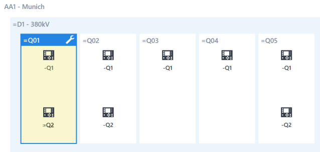
Figura 6 Modo de mantenimiento activado para la bahía Q01
