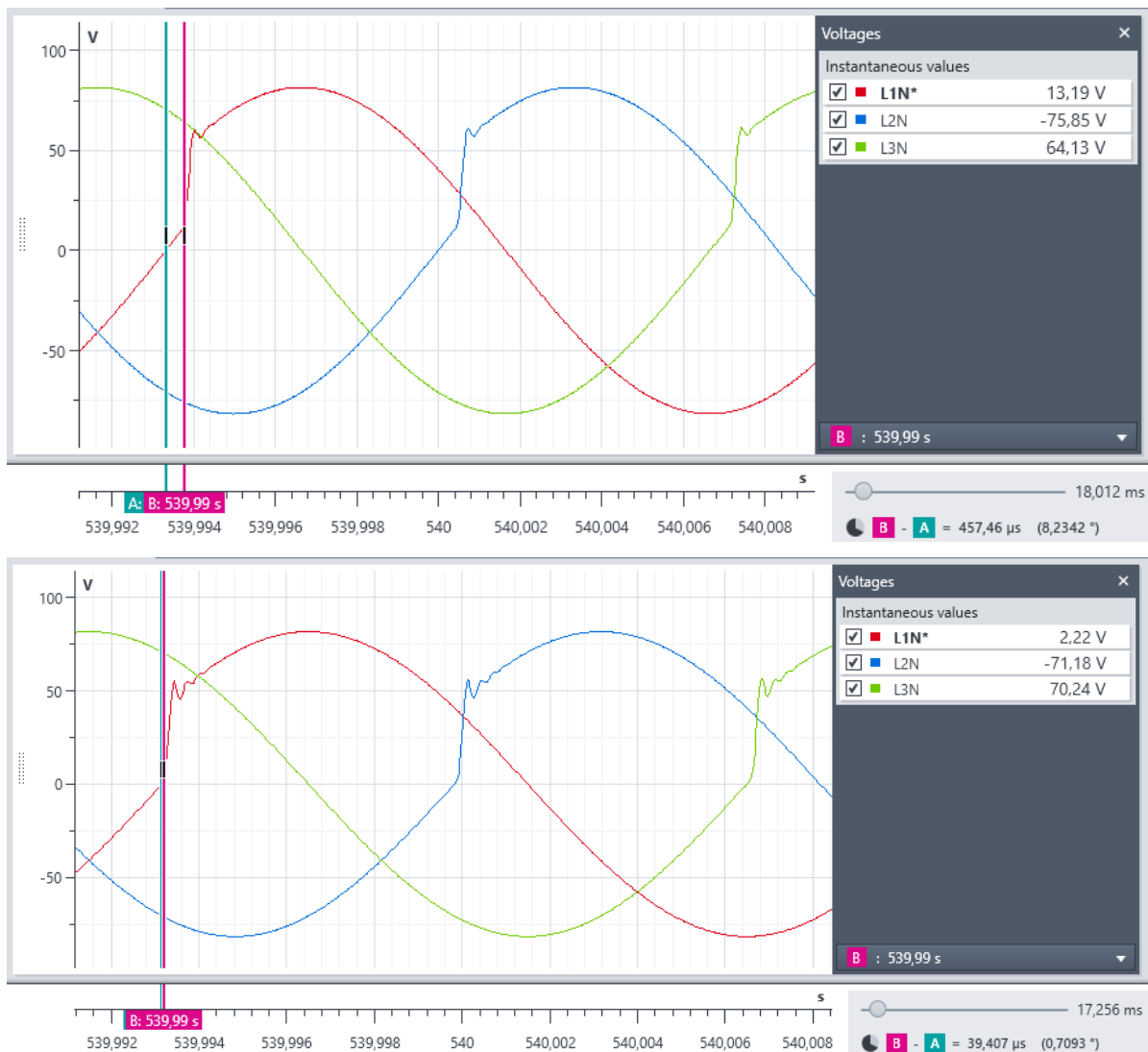
Figura 5: Señales de salida de la prueba de saltos de fase; a) sin redondeo apropiado (superior); b) con redondeo apropiado (inferior)
