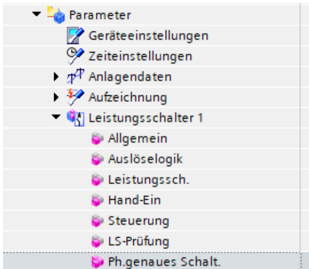
Figure 11b : Paramètre de synchronisation de phase dans le groupe de fonctions Disjoncteur
