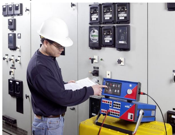
Image 15 : Tests manuels rapides avec le CMControl pour des tests simples
